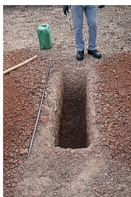
(a) Sondage manuel (puits à ciel ouvert).
