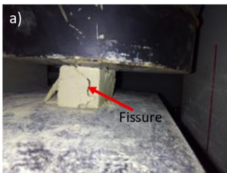
Fig. 13. Échantillon avec 40 mm de fibres de coco : a) Après le test en compression ; b) Image montrant la décohésion des fibres ; c) Image MEB d'une fibre dans la matrice fissurée.
