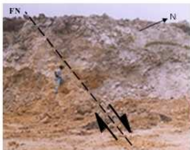
Photo 3: Déformations dans les calcaires (Carrière de Tabligbo). FN: Faille normale
