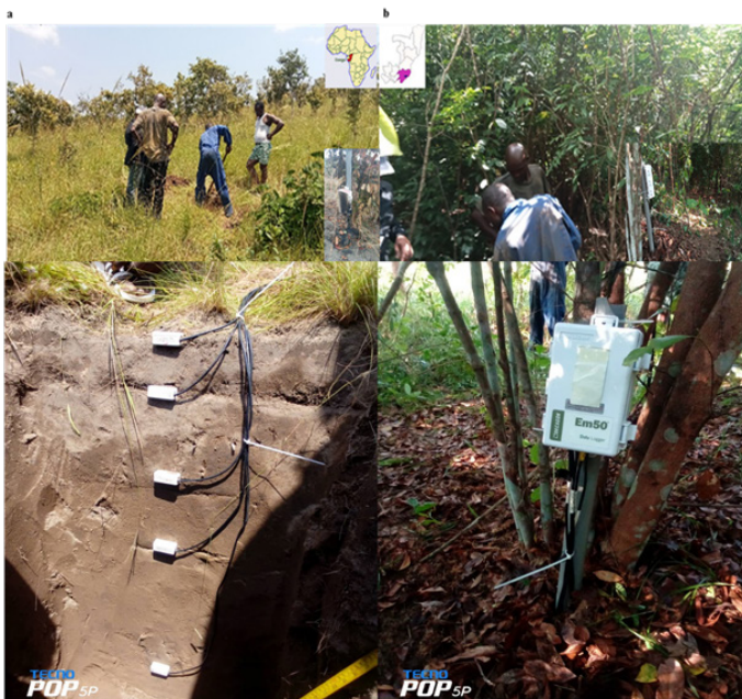
Photo 2 : Installation des enregistreurs d'humidité (Em50 Decagon) a) en savanes et b) en forêt
