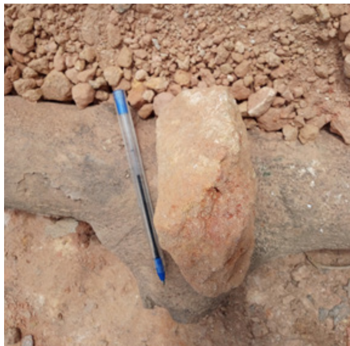
Figure 4. Macrophotographie de l'échantillon de latérite argileuse prélevé sur la colline de Kokumbo Bocca.
