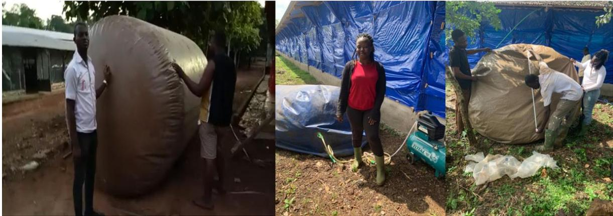
**Fig. 2.** Dispositif de stockage du biogaz.
