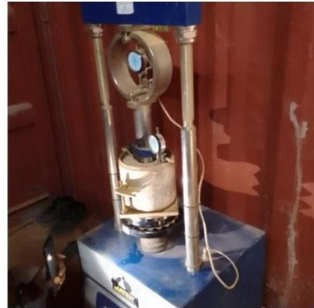
Fig. 6. Appareil de poinçonnement.
