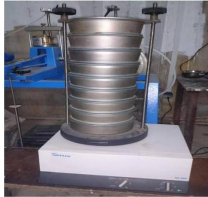
Fig. 3. Équipement de l'analyse granulométrique.
