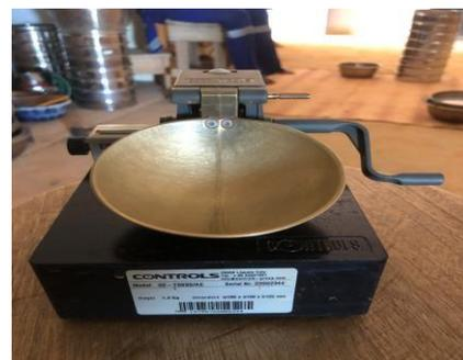
Fig. 5. Appareil de Cassagrande.
