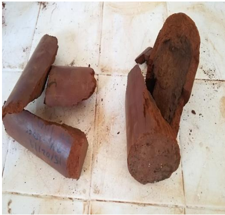
Fig. 6. BTCS (à gauche) et BTC (à droite) après traitement à 350 °C.
