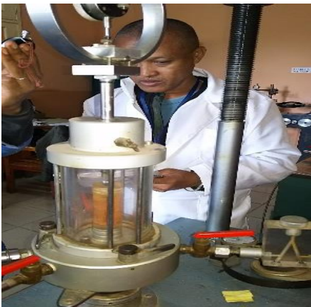
Fig. 1. Vue de la cellule triaxiale pour la mesure de contrainte.
