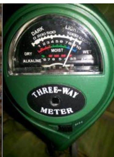
**Fig. 3.** pH-mètre « Three-waymeter » pour la mesure du pH.
