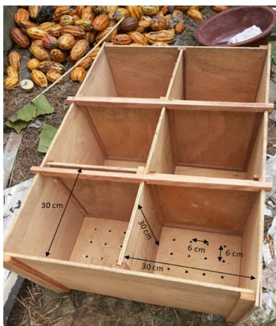
**Fig. 1.** Fermenteur expérimental.
