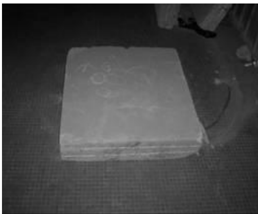
Figure 3 : Échantillon du composite bois ciment
