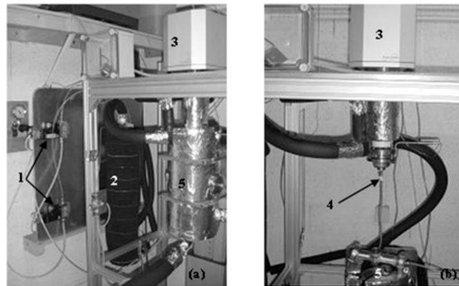
Figure 1. Photos du dispositif expérimental (a) en position de mesure (b) enceinte isotherme à double paroi abaissée pour accéder à l'échantillon. 1 : débitmètres, 2 : saturateur, 3 : balance, 4 : échantillon, 5 : enceinte à double parois
