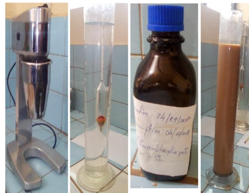
Figure 4 : Agitateur mécanique, densimètre dans une éprouvette, solution d'hexaméthaphosphate de sodium, éprouvette du mélange.
