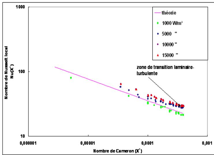
Figure 7. Evolution de la CMC en écoulement monophasique en fonction du nombre de Cameron pour différentes densités de flux de chaleur  $Re = 1126$ .
