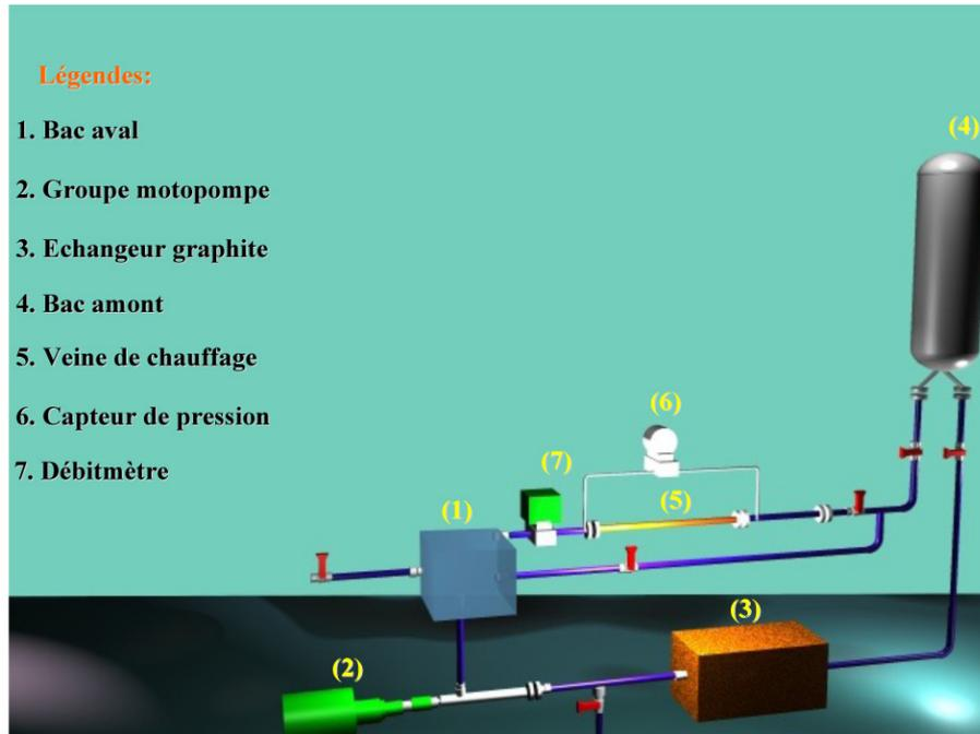
Figure 5. Schéma de la boucle d'essais
