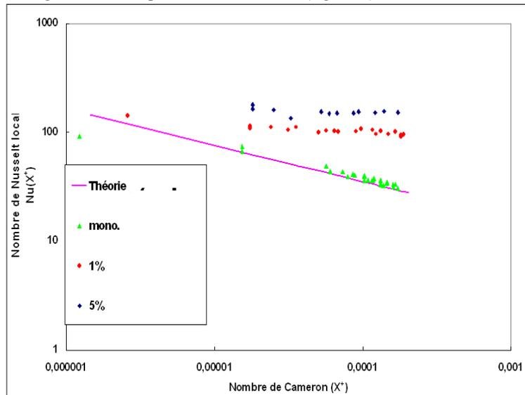
Figure 9. Evolution du nombre de Nusselt local en fonction du nombre de Cameron pour différentes fractions volumiques pour une densité de flux de chaleur constante  $\phi_p$  égale à  $5000 \text{ W/m}^2$  à une vitesse  $U_d$  constante égale à  $3,44 \text{ m/s}$ .
