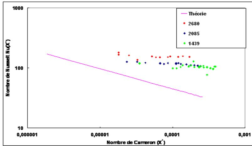
Figure 8. Evolution du nombre de Nusselt local en fonction du nombre de Cameron pour différentes valeurs de débit (le nombre de Reynolds basé sur la viscosité apparente avec la suspension de CMC chargée à 5% et à la densité  $\phi_p = 5000 \text{ W/m}^2$ ).
