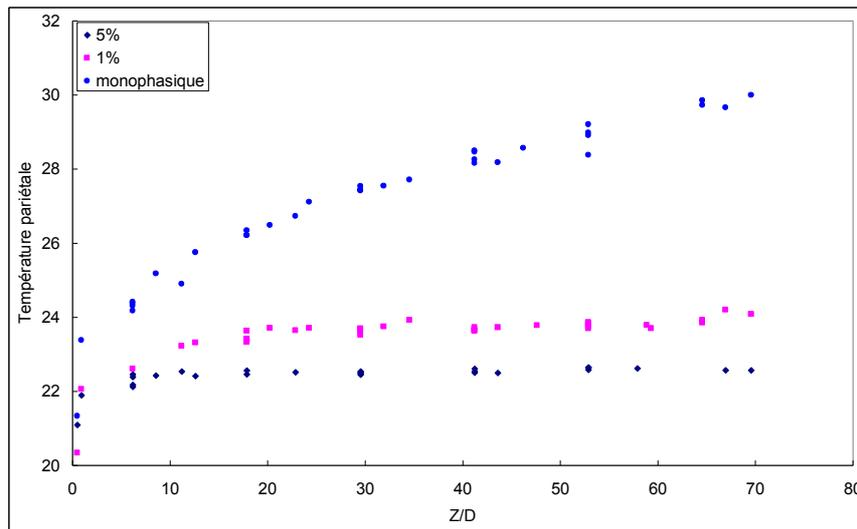
Figure 10. : Evolution longitudinale de la température à la paroi – CMC à la vitesse de l'écoulement  $U_d$  constante égale à 2,11 m/s et à la densité de chaleur constante  $j_p$  égale à 5000 W/m<sup>2</sup>.
