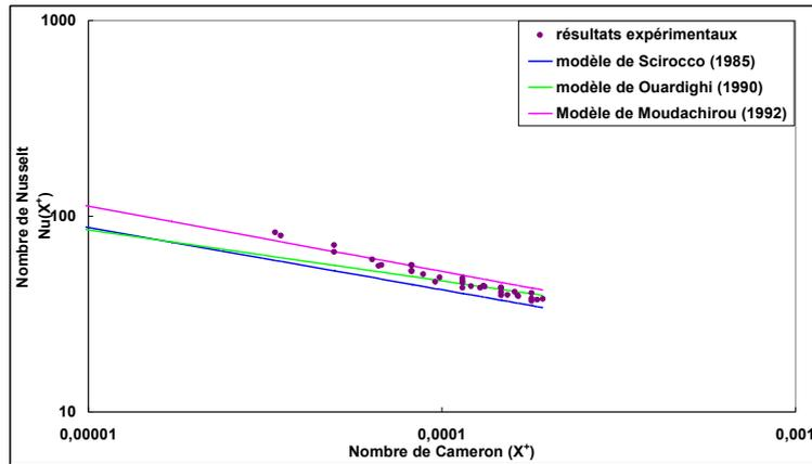
Figure. 6. Etude comparative des modèles de Scirocco (1985), d’El Ouardighi (1990) et de Moudachirou (1992) à la densité de flux de chaleur  $\phi_p$  constante égale à  $15\,000\text{ W/m}^2$  et la vitesse  $U_d$  constante égale à  $3,83\text{ m/s}$  ( $Re = 876$ ).
