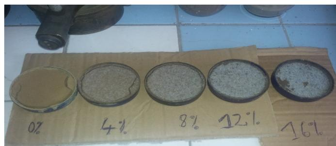
**Figure 8: galettes d'argile après 72 heures de séchage**
