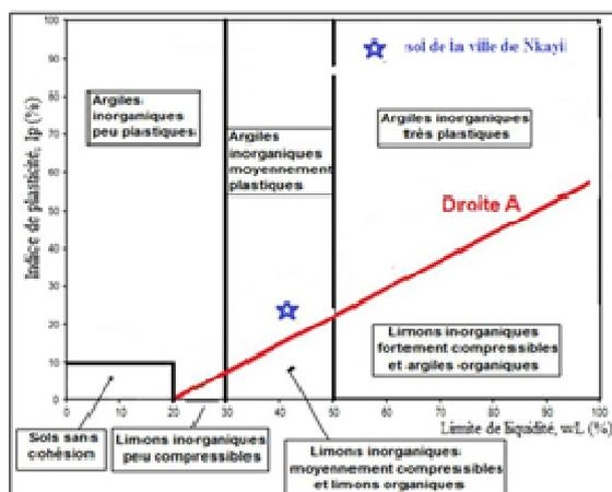
Figure 4: Diagramme de plasticité de Casagrande du sol de Nkayi
