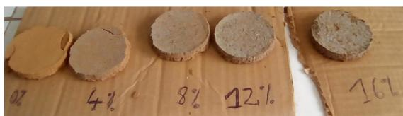
**Figure 11: galettes d'argile secs démontées après 144 heures de séchage**
