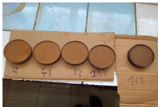
Figure 6: galettes d'argile après 24 heures de séchage
