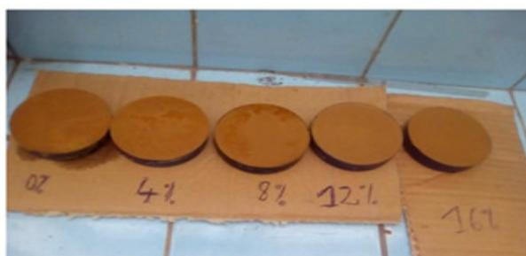
Figure 5: Pâte d'argile dans les moules avant séchage de plasticité de Casagrande du sol de Nkayi
