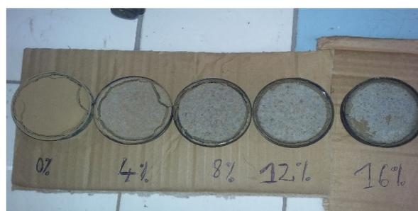
**Figure 9: galettes d'argile après 96 heures de séchage**
