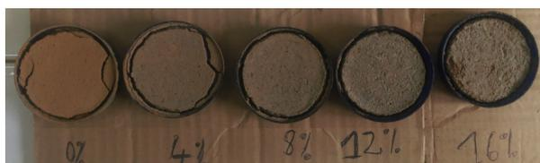
**Figure 10: galettes d'argile après 144 heures de séchage.**
