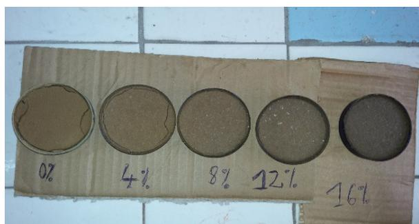
**Figure 7: galettes d'argile après 48 heures de séchage.**
