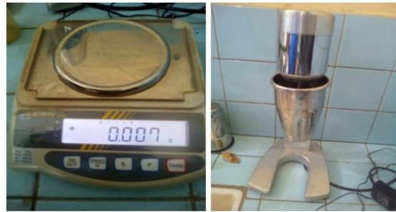
**Figure 3: Balance électronique de précision 0,001g et agitateur électrique utilisé**
