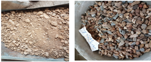
Figure 3 : A gauche la grave alluvionnaire 0/31,5 brute et à droite celle lavée.
