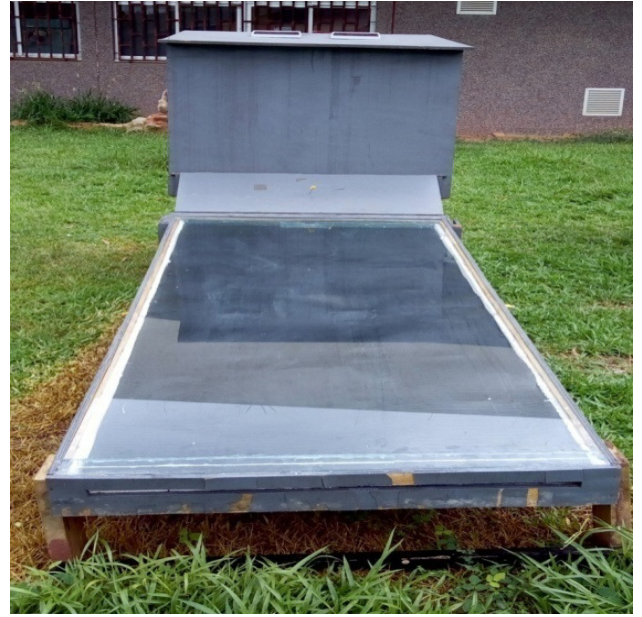
Figure 1. Photo du séchoir solaire indirect
