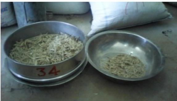
Figure 8. Tamisage des fibres de bagasse (résidu de canne à sucre après pressage).
