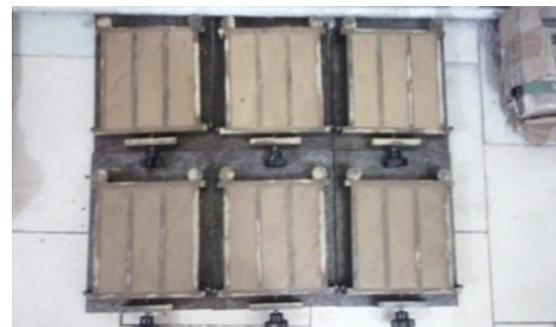
Figure 7. Briquettes sur moules
