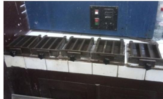
Figure 6. Moules utilisés pour la confection des briques.
