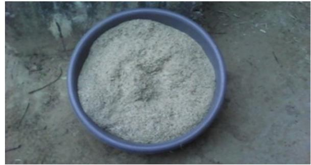
Figure 9. Fibre de bagasse tamisée
