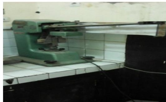
Figure 12. Appareil utilisé à l'essai de traction, type 41,5 numéro 50
